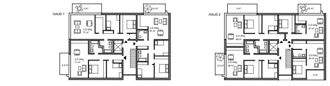
GRUNDRISS | 1. und 2. OBERGESCHOSS | M. 1:200
